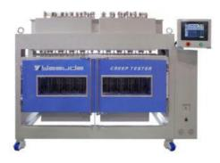
JIS-K7115, ASTM-D2990, ISO-899-1(CREEP TEST), JIS-K6263, ISO-3384(STRESS RELAXATION TEST)
